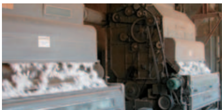
La sgranatrice separa le fibre dei semi che saranno utilizzati come foraggio, per produrre l'olio di cotone o come semente
